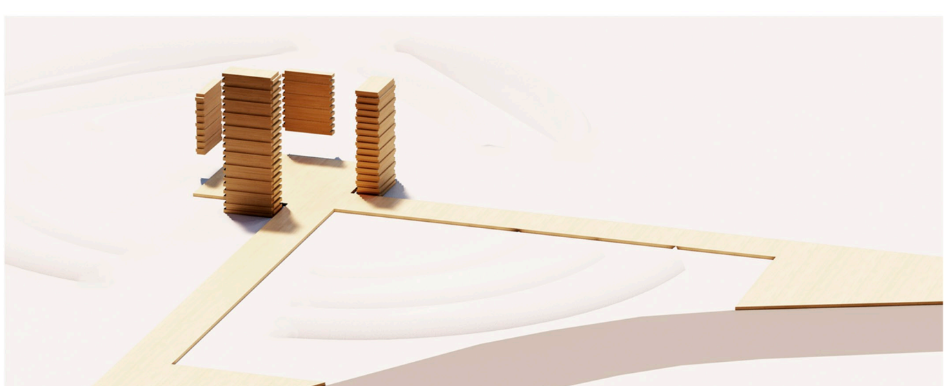
02 – As rochas são montadas sobrepostas em placas de 1.25x0,50x0,15 cm e delimitam a Gruta.
